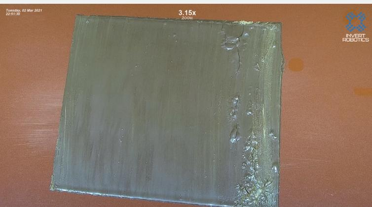
Ein neuer Riss an einer bereits reparierten Stelle. Rückstände, die sich in dem Riss ablagern, führen auf die Dauer zu Blasen unter der reparierten Stelle.
