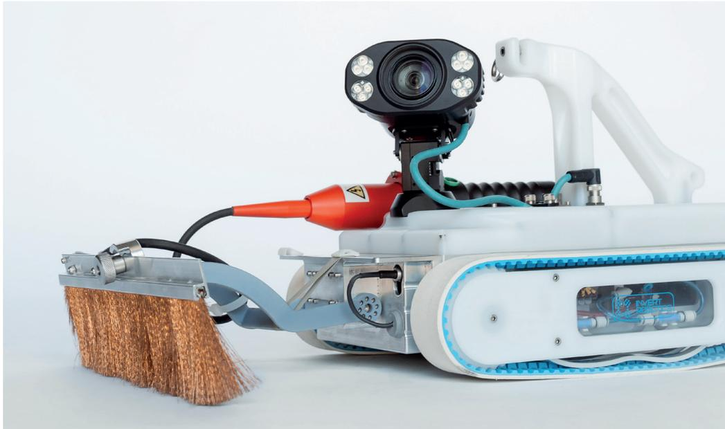
**Die speziell für nichtleitende oder halbleitende, lackierte, emaillierte oder beschichtete Rohre und Behälter entwickelte Funkenprüfung ist eine hochgenaue ZfP-Technologie. Sie wird in der Regel gleichzeitig mit der Sichtprüfung von Anlagen eingesetzt, wenn potenzielle Schäden an der Oberfläche oder Beschichtung einer Anlage festgestellt werden.**
